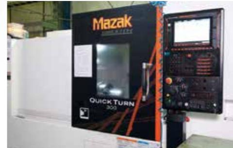
NC旋盤10インチ QUICKTURN300
